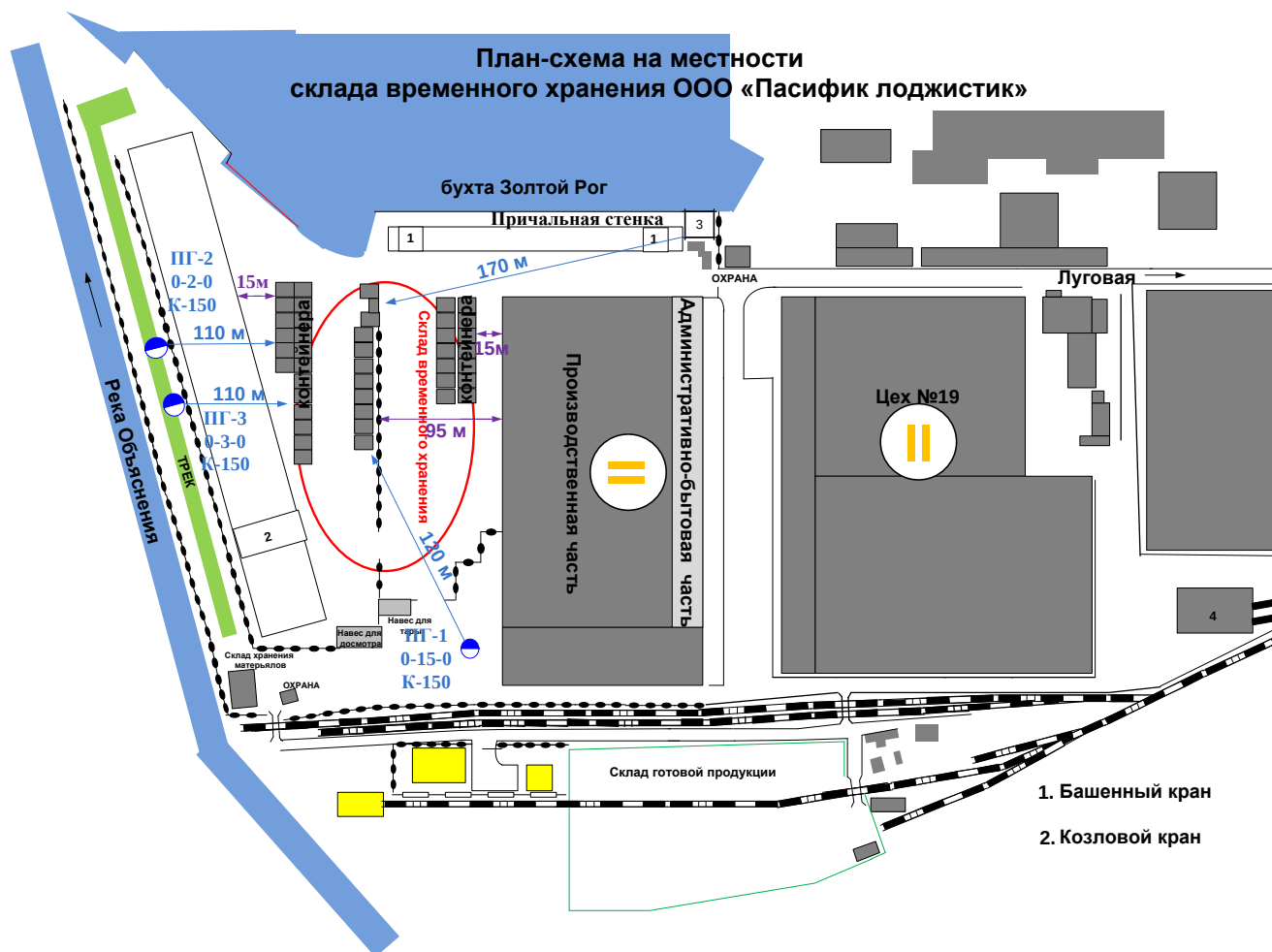
Рис.6.2.1. Схема противопожарного водоснабжения.
